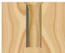
Esempio di foro cieco con svasatura
