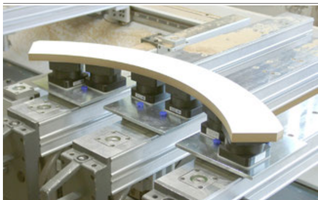
Adapter-Plate ISAP-K2 con Mono-Base y ventosas fijando piezas de madera
