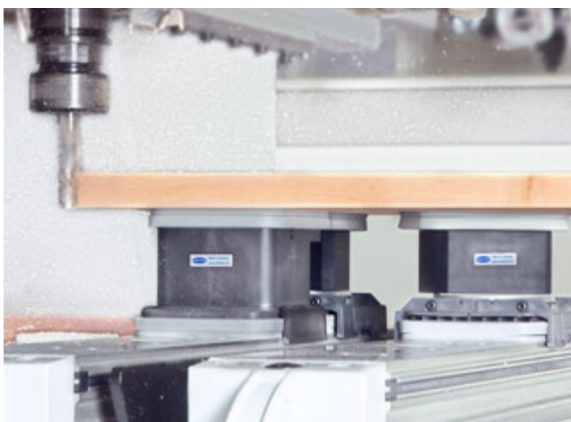
Ventosa de bloque VCBL-K2 durante el mecanizado de una plancha de madera
