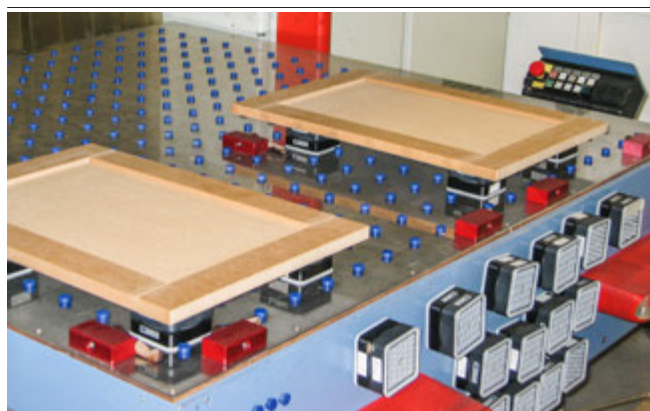
Steel-Plate de Innospann con Mono-Base y bocas de ventosa
