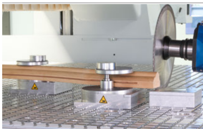
Fijación mecánica VCMC-R para madera agobiada
