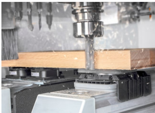
Ventosa de bloque VCBL-K1 en funcionamiento combinado con la Adapter-Plate ISAP-K1 durante el mecanizado de una plancha de madera
