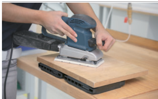
Placa de ventosa Multi-Clamp VC-M-SP en el mecanizado manual de una pieza de madera
