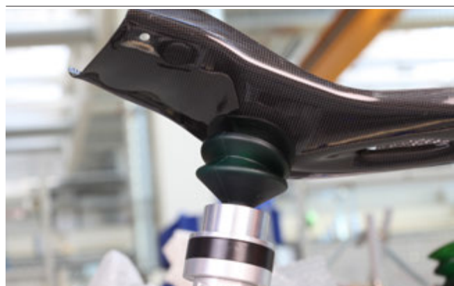
Uni-Base UB y Reference-Cup RSC fijando un componente de PRFC
