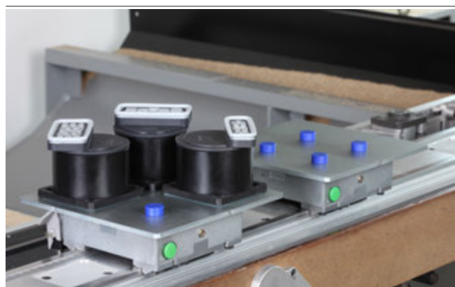
Adapter-Plates ISAP-B con Mono-Base y ventosas fijando piezas de madera
