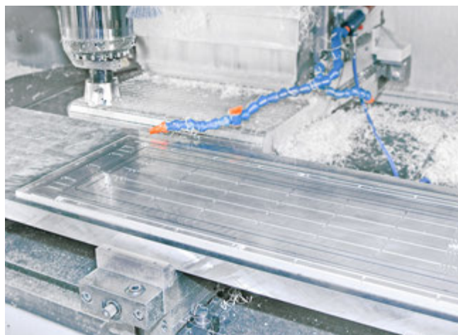
Sistema de fijación por vacío Matrix-Plate con un diseño personalizado durante el mecanizado de una plancha de plástico
