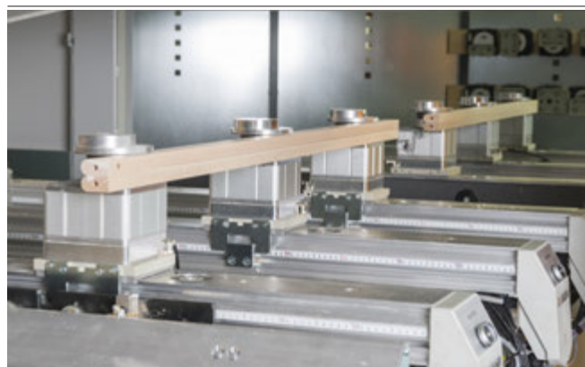
Fijaciones mecánicas VCMC-K1 fijando piezas de marco
