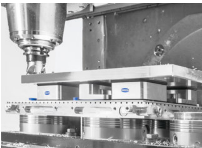
Matrix-Plate MPL con steel-plate de Innospann ISST-MPL y ventosas de bloque ISBL para el taladrado en el mecanizado CNC
