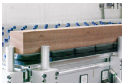
Steel-plate de Innospann montada en una mesa lisa
