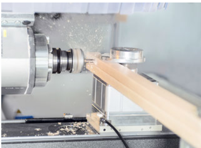
Fijación mecánica VCMC-K1 durante el mecanizado de piezas de marco delgadas
