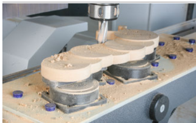
Adapter-Plates ISAP-K1 con Mono-Base y ventosas fijando piezas de madera acodadas
