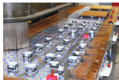
Steel-plate de Innospann montada en una mesa con cuadrícula
