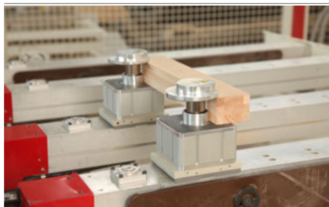
Fijaciones mecánicas VCMC-K2 sujetando piezas de marco
