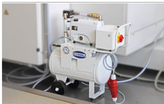
Unidad de vacío VAGG para la generación de vacío en el mecanizado húmedo
