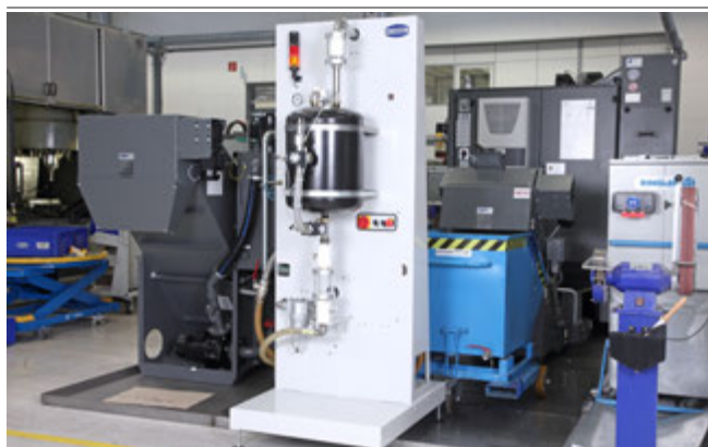
Vacuum Operation Center VOC para la generación de vacío en el mecanizado húmedo
