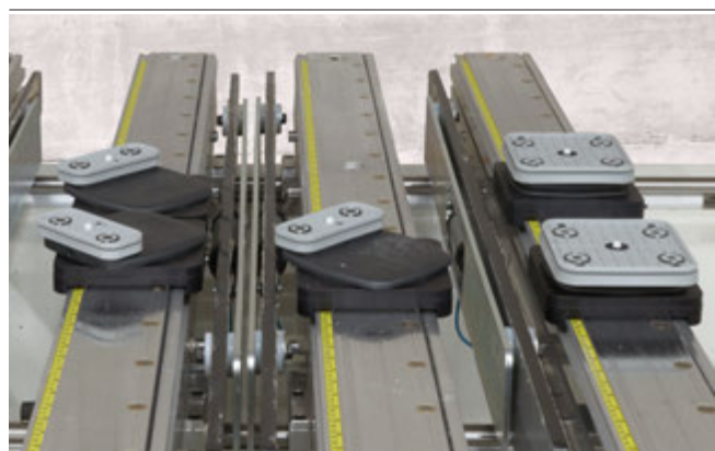
Adapter-Plate AP-S4 ventosas de bloque VCBL-B fijando piezas de madera para geometrías diferentes
