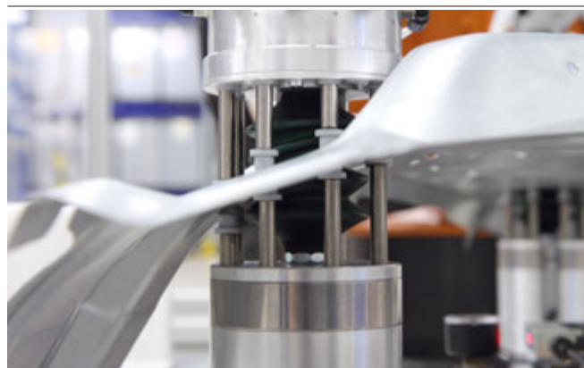
Agarre y fijación automatizados de una pieza metálica con la boca de ventosa SSCB
