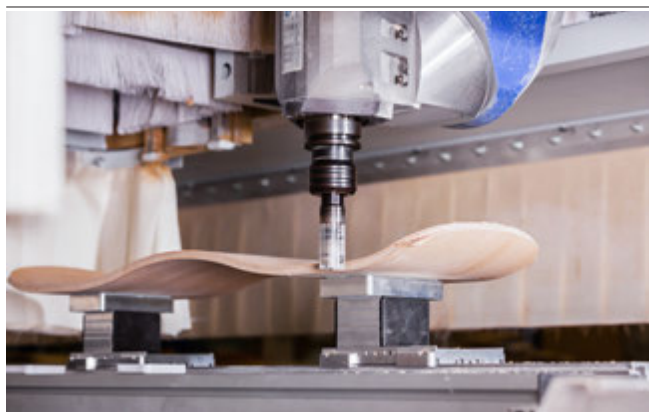
Ventosa de bloque de aluminio VCBL-A-K2 sujetando madera maciza
