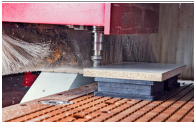
Ventosa de bloque VCBL-R fijando un tablero de madera aglomerada
