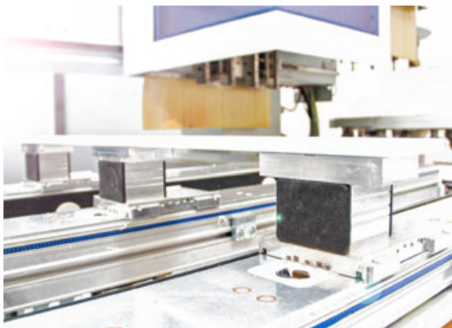
Ventosa de bloque de aluminio VCBL-A-K2 durante el mecanizado de partes de muebles
