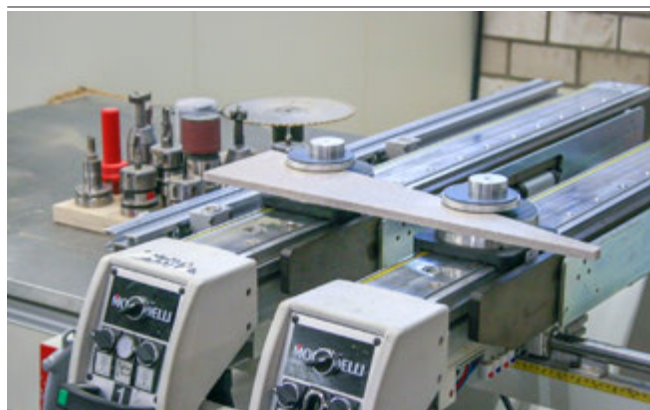
Fijaciones mecánicas VCMC-S4 fijando piezas de madera
